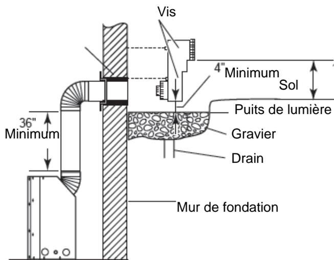
**Schéma 23 – Installation sous le niveau du sol**
