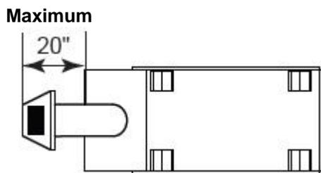
**Schéma 11 - Ventilation arrière, distance horizontale maximum**
