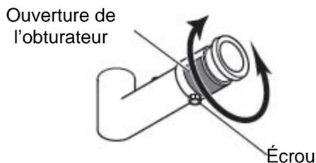
**Schéma 47 - Réglage de l'obturateur d'air**
