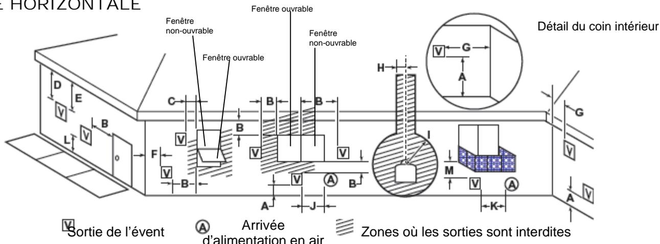
**Schéma 8 – Emplacements de sortie d'évacuation horizontale**
