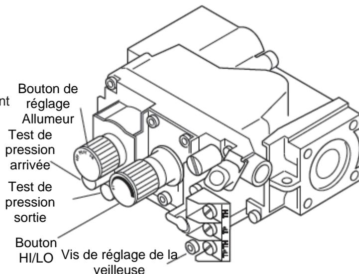
Schéma 34 – Vérification de la pression du gaz à la valve
