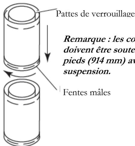
**Schéma 13 - Raccords de tuyaux d'évacuation rigides**
