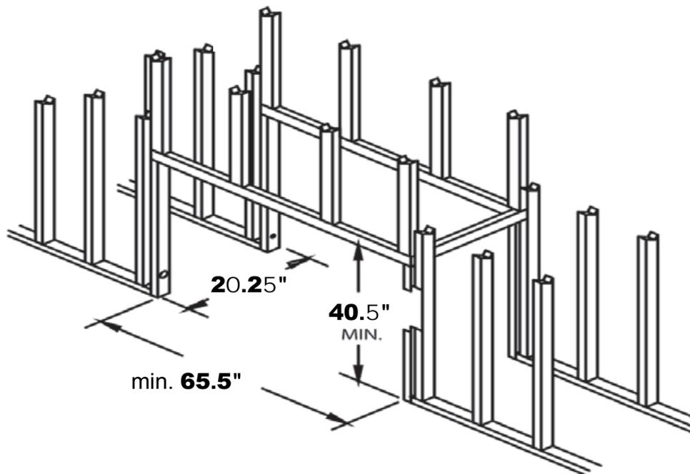
Schéma 4 – Dimensions extérieures minimum du matériau de recouvrement de la devanture
