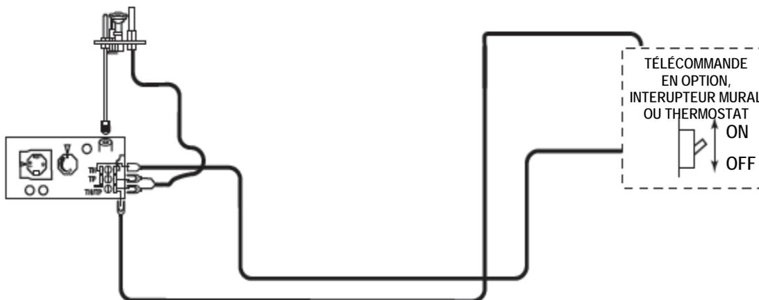
Schéma 35 – Diagramme de câblage pour l'interrupteur mural
