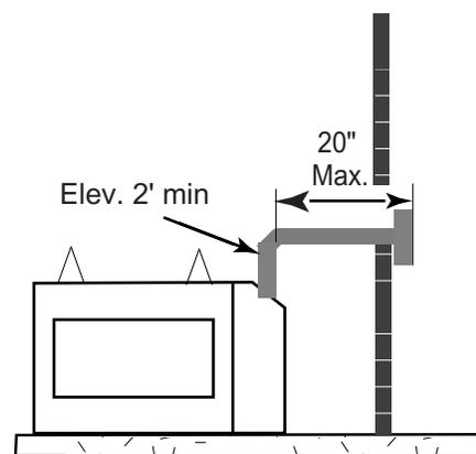
**Schéma 19 – Parcours maximum horizontal avec une élévation de 2'**
