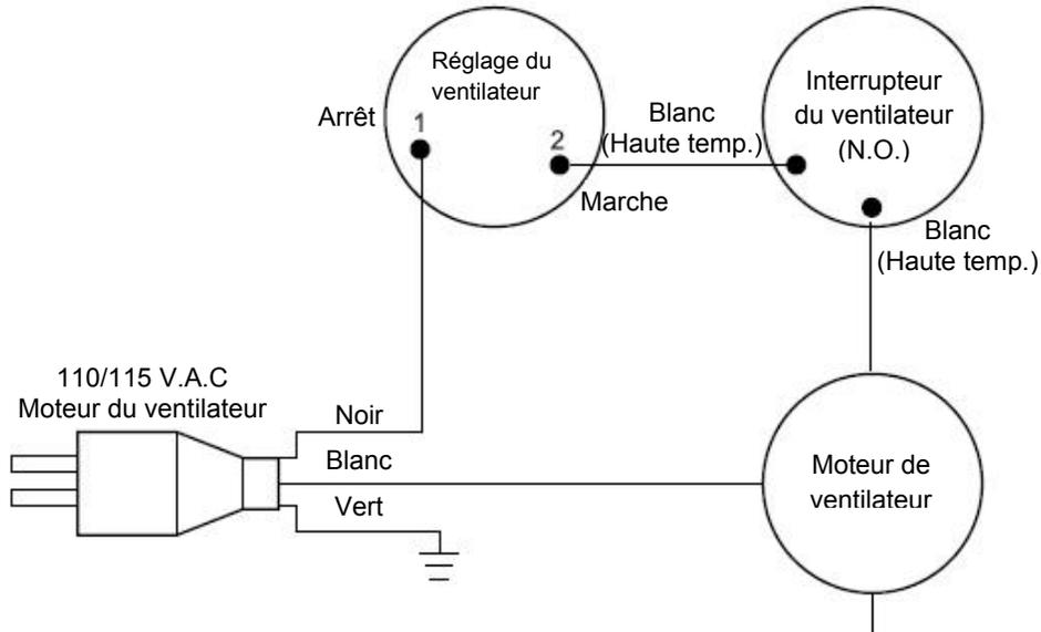
Figure 41 – Diagramme du câblage du ventilateur
