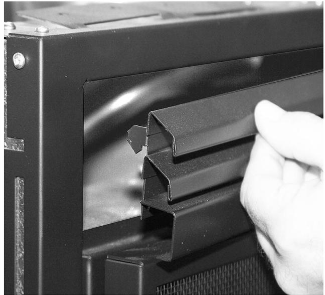
Etape 6 : Maintenez le haut ailette avec deux mains. Repérez les crochets verticale des deux côtés des buses et les plaques de montage en forme de L dans la cheminée. Positionner le déflecteur dans la cheminée ouverture pour l'accrocher sur les supports de montage.
