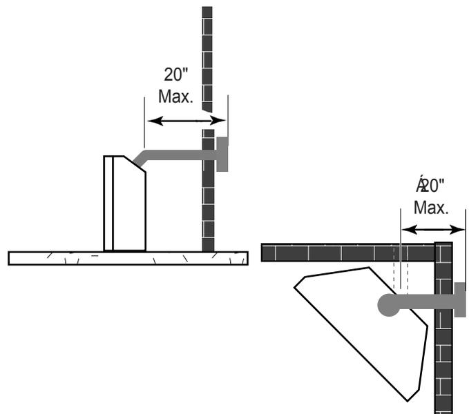
Schéma 19 – Conduit horizontal maximum sans élévation
