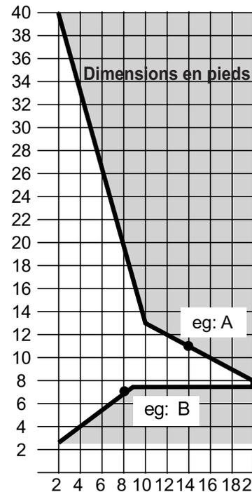
Dimensions verticales à partir du plancher jusqu'au centre du tuyau horizontal
