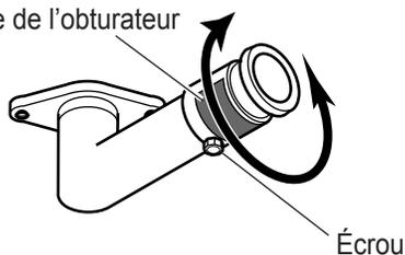
Schéma 54 - Ajustement du déclencheur d'air
