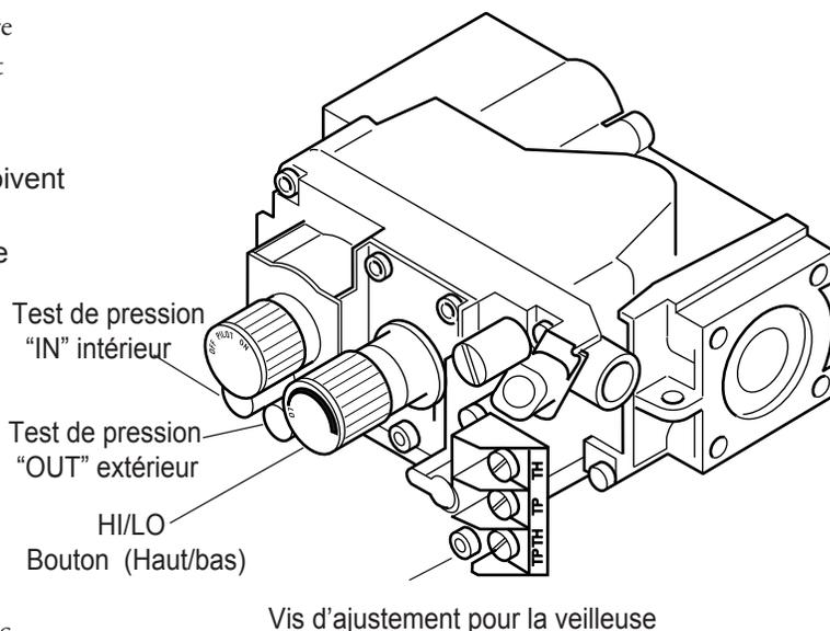
Schéma 34 - La pression de gaz contrôlée au niveau de la soupape à gaz
