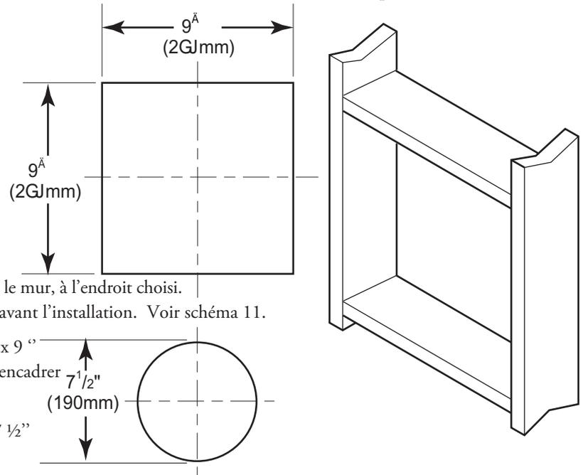
1. Localiser et Découpez l'ouverture pour la ventilation dans le mur, à l'endroit choisi. Si les murs sont inflammables, encadrer votre ouverture avant l'installation. Voir schéma 11.
